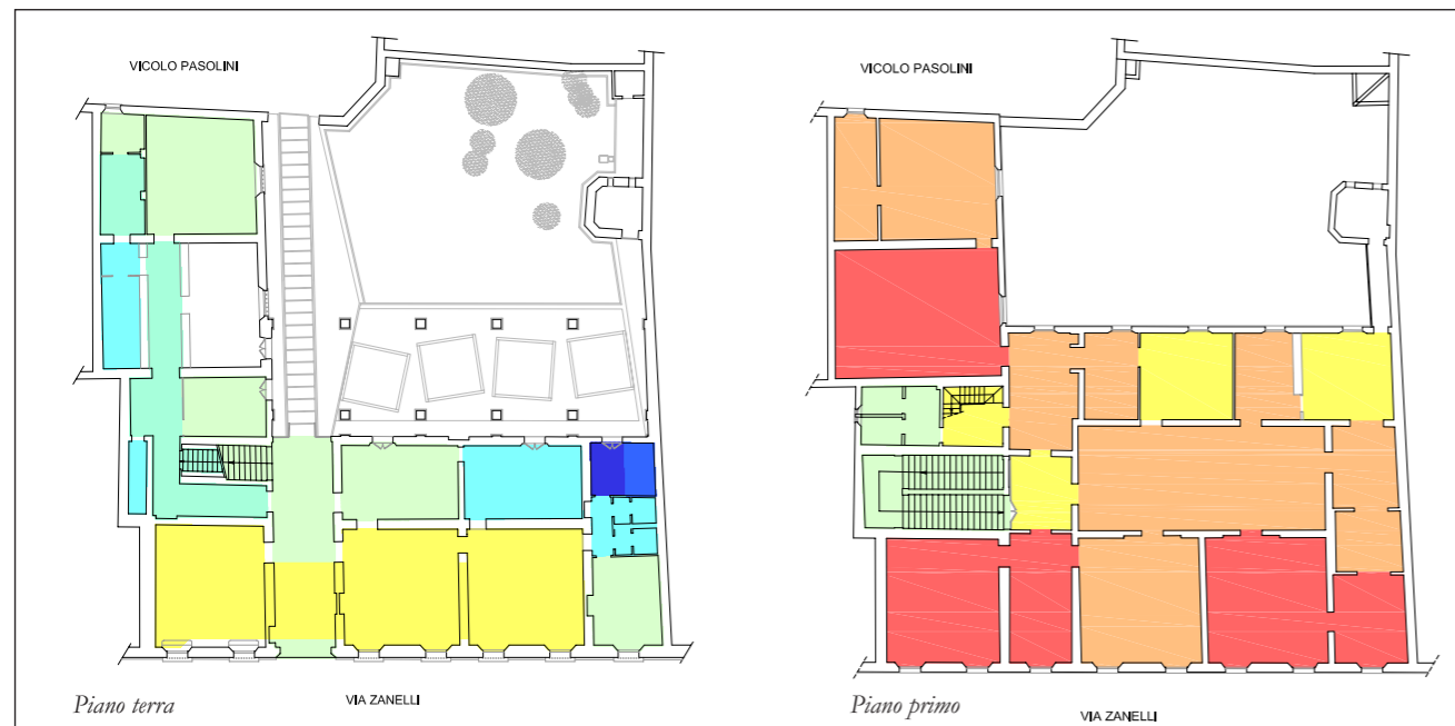
Analisi delle temperature nei vari ambienti simulate per il giorno considerato più caldo dell'anno - 15 luglio alle ore 12.00.
