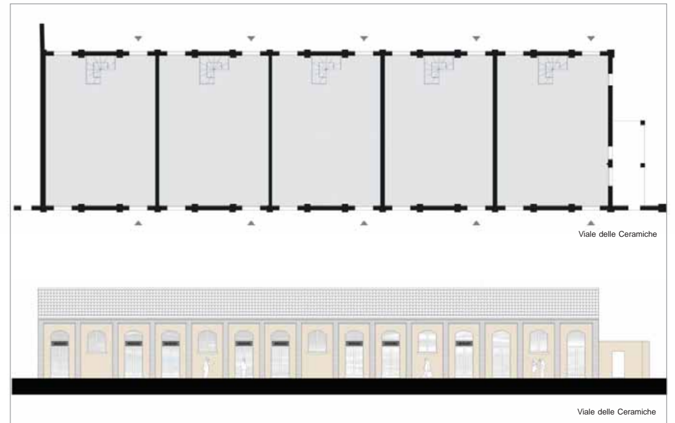
Il progetto: cinque nuovi spazi commerciali e/o residenziali per valorizzare un angolo di Faenza oggi poco frequentato. Planimetria del piano terra e prospetto su viale delle Ceramiche.
