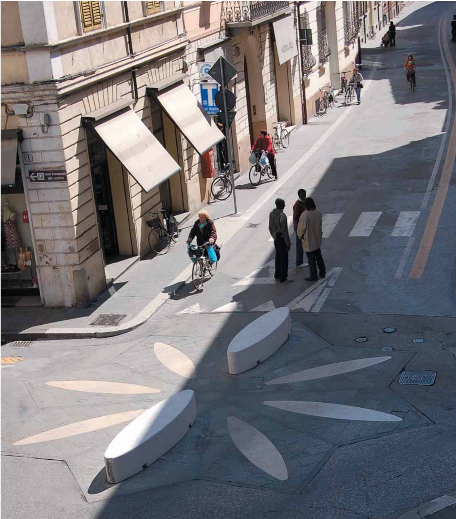
Intersezione tra Corso Mazzini, Via Cavour e Corso Baccarini. Un incrocio stradale lungo il decumano massimo è risolto con un'artistica soluzione in pietra bianca: un fiore a sei petali. Due di questi, rialzati da terra, diventano un dissuasore per evitare il passaggio delle auto. Le soluzioni innovative e sperimentali si possono applicare a qualsiasi tema urbano. Un intervento che, con la sua forma semplice, si sposa bene con il contesto.
